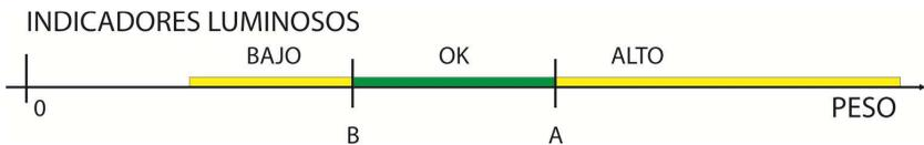
Al colocar el producto a clasificar sobre la balanza, y con el peso estable, el indicador clasifica el peso y activa el indicador luminoso correspondiente.
